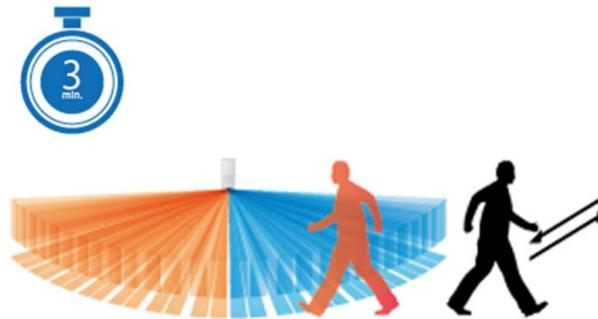
Le mode test de marche s'arrête après 3 minutes et revient en mode "normal".
